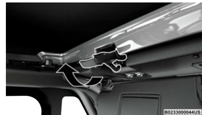
両方のヘッダ・ラッチをかみ合わせる
