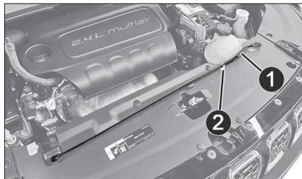
4. サポートロッドをボンネット側の溝③に差し込み、ボンネットが下がらないように支えます。
