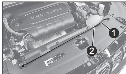
4. サポートロッドをボンネット側の溝③に差し込み、ボンネットが下がらないように支えます。
