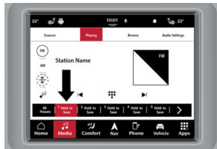
Uconnect 5/5 NAV (8.4 インチ・ディスプレイ装備車) のプリセットの設定
