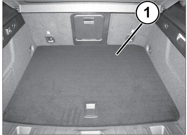
4. 高電圧システム無効化装置の保護カバー (1) を取り外す。
